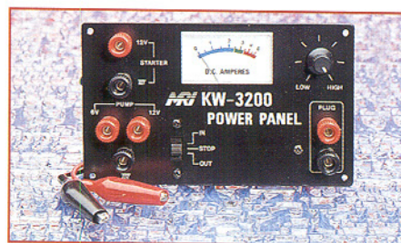
Bild 15: Komfortabel - ein Startpanel versorgt mehrere Komponenten definiert mit Strom.
